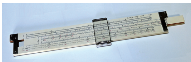
Fig. 12 筆者が使っていた両面セルロイド表面ヘンミ・バンパー計算尺、No.259。
